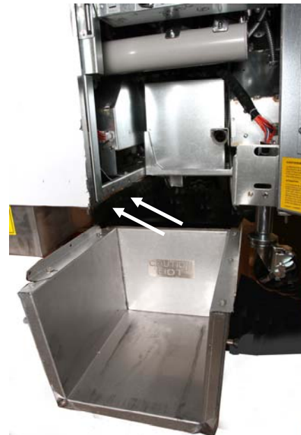
Рис. 1. расположите устройство для растапливания в шкафу, прикрепив входящими в комплект поставки винтами к внутренним компонентам.
