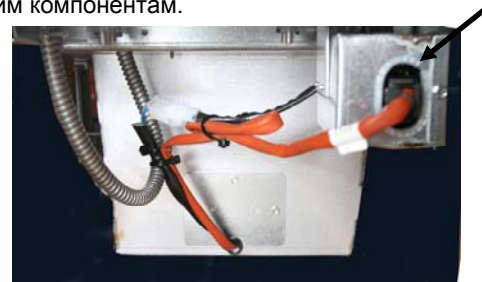
Рис. 3. Вставьте черный соединитель во вспомогательный разъем, см. рисунок. Отдельный пучок проводов с белым штекером, при наличии такового, НЕ должен использоваться.
